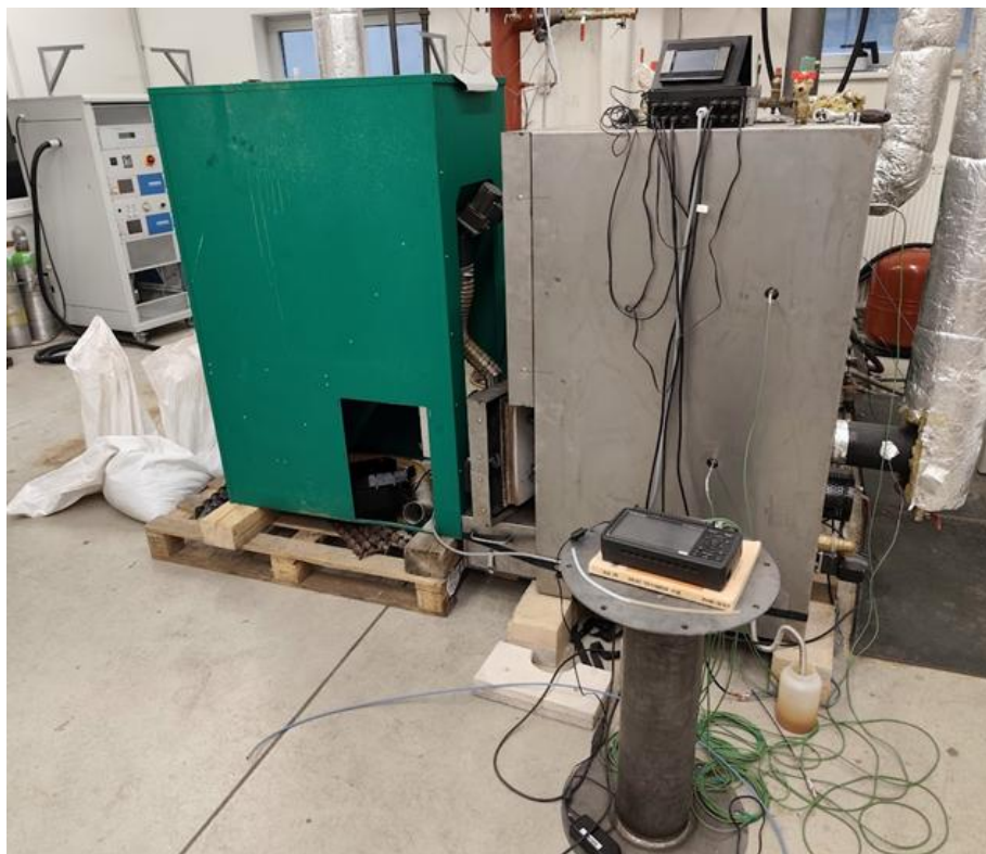
Obr. 3 Prototyp kotle 24 kW instalovaný na zkušebně
